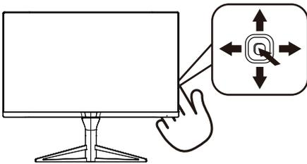
Um das Bildschirmmenü auf diesem Philips-Monitor aufzurufen, verwenden Sie die Umschalttaste an der Rückseite des Monitorrahmens. Diese Taste funktioniert wie ein Joystick. Um den Cursor zu bewegen, bewegen Sie die Taste in vier Richtungen. Drücken Sie die Taste, um die gewünschte Option zu wählen.
