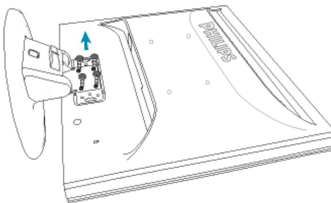
**Observación:** Este monitor admite sistemas de montaje VESA de 100 x 100 mm.
