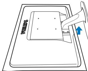
2. Da bi podstavek sneli z opore podstavka, pritisnite na zaklepni sponki.
