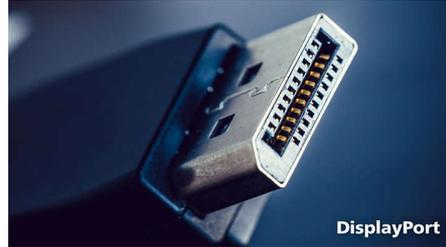
DisplayPortは、データを変換せずにPCからモニターへ転送するデジタルリンクです。DVI基準よりも高い性能を持つこのポートは、最長15メートルのケーブルに対応し、最高10.8 Gbps/秒のデータ転送を行うことができます。この高いパフォーマンスと無遅延により、最速のイメージン
