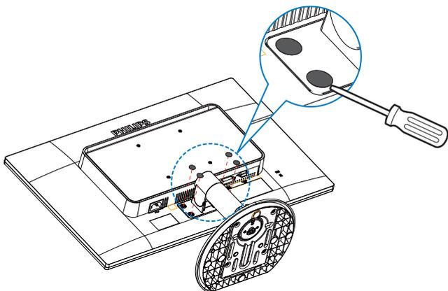
3. Uklonite odvijače s poklopca zgloba.
