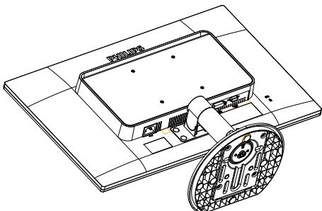
2. S ploščatim izvijačem odstranite štiri kapice na pokrovu tečaja.
