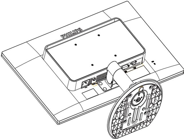
2. Χρησιμοποιήστε ένα κατσαβίδι επίπεδης κεφαλής για να αφαιρέσετε τέσσερα μπιλάρ από το κάλυμμα του αρμού.
