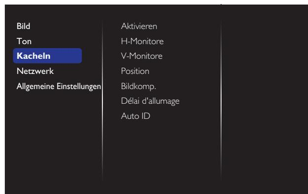
Mit dieser Funktion können Sie eine einzelne große Bildschirmmatrix (Videowand) erstellen, die aus bis zu 100 Anzeigeräten besteht (**bis zu 10 Geräte je Spalte/Zeile**).
