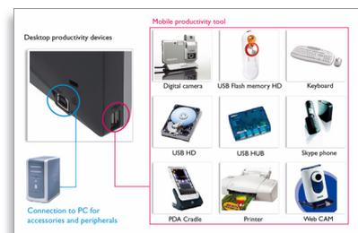
El bus serie universal o USB es un protocolo estándar para conectar ordenadores y periféricos. Dado que ofrece alta velocidad a bajo coste, el USB se ha convertido en el método más común de conexión de dispositivos periféricos a un ordenador. Un puerto ubicado en un monitor directamente en la línea de visión del usuario proporciona una fácil conectividad de alta velocidad para los dispositivos USB en una ubicación cómoda. (La compatibilidad USB 2.0 depende de la configuración USB del ordenador.)
