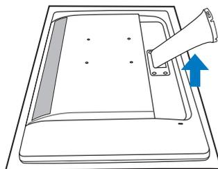
2. Tenere la base del monitor con entrambe le mani ed inserire con fermezza la base nel supporto.
