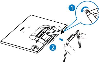
3. Gunakan obeng untuk melepas sekrup pada penutup engsel, lalu lepas penutup engsel.
