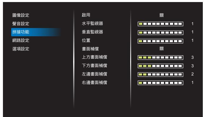
建立由最多 225 部顯示器（垂直最多 15 部且水平最多 15 部）組成的大型螢幕矩陣（電視牆）。
