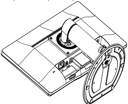
2. S ploščatim izvijačem odstranite štiri kapice na pokrovu tečaja.
