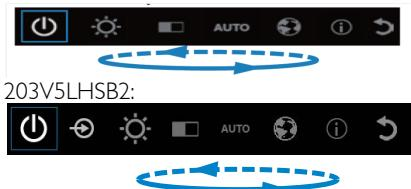
4. Sada možete odabrati bilo koju funkciju brzim uzastopnim pritiskanjem donje tipke. Plavi okvir će vas voditi udesno kada pritisnete tipku. Donju tipku možete otpustiti kada plavi okvir istakne opciju koju želite odabrati. Zapamtite da se odabir odvija kružnim tokom u jednom smjeru, vraćajući se uvijek na početak izbornika.
