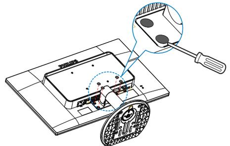
3. Entfernen Sie die Schrauben von der Gelenkabdeckung.
