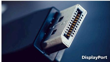
DisplayPort ist ein digitaler Anschluss vom PC zum Monitor ohne Konvertierung. Mit höheren Kapazitäten als DVI kann dieser Standard bis zu
