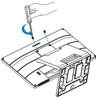
2. Μετακινήστε το στήριγμα στη θέση που φαίνεται στην εικόνα. Υστερα χρησιμοποιήστε ένα κατσαβίδι για να αφαιρέσετε τις βίδες και ύστερα αποσυνδέστε το στήριγμα από την οθόνη.
