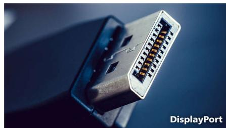
Mit dem DisplayPort-Ausgang können Sie mehrere hochauflösende Bildschirme mit nur einem Kabel über Ihr Hauptdisplay an Ihren PC anschließen. Durch die Reihenschaltung mehrerer Bildschirme erhalten Sie einen übersichtlichen Desktop ohne überflüssige Kabel.
