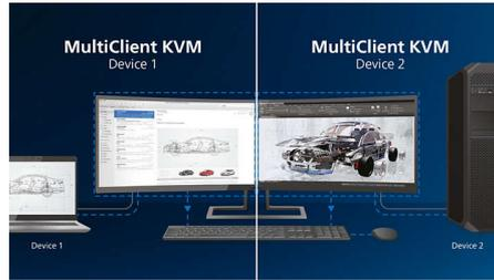
マルチクライアント統合型 KVM スイッチなら、1 組のモニター、キーボード、マウスをセットアップするだけで、2 台の PC を制御可能。便利なボタンですばやくソースを切り替えることができます。PC 2 台分の演算能力を必要とする場合や、それぞれの PC の表示用に 1 台の大きなモニターを共有したい場合などにも、設定が簡単です。
