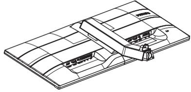
2. Usare le dita per serrare la vite situata nella parte inferiore della base e fissare saldamente la base al supporto.
