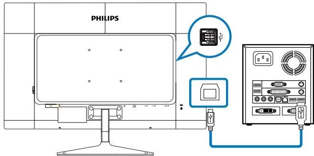
1. Подключите USB-кабель от ПК к USB-разъему типа B на панели входа/выхода монитора.
