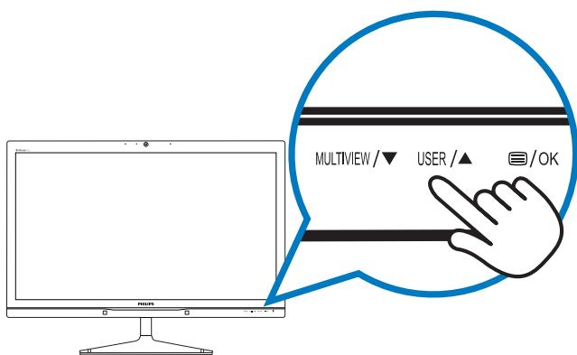
Например, если элемент [Audio Source] (Источник аудиосигнала) назначен горячей клавишей, при нажатии на кнопку **USER** на передней панели на экран выводится меню [Audio Source] (Источник аудиосигнала).
