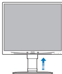
2. Положите монитор экраном вниз на ровную устойчивую поверхность, соблюдайте осторожность, чтобы не поцарапать и не повредить экран. Поднимите подставку монитора.
