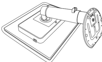
3. Удерживая кнопку освобождения в нажатом состоянии, наклоните основание и вытащите его.
