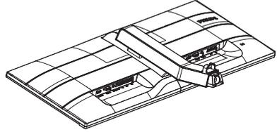
2. Χρησιμοποιήστε τα δάχτυλά σας για να σφίξετε τη βίδα που βρίσκεται στο κάτω μέρος της βάσης ασφαλίστε τη βάση στο στήριγμα σφιχτά.
