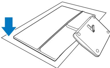
2. Удерживайте монитор и подставку обеими руками. Осторожно надавите на подставку так, чтобы она наклонилась и зафиксировалась под углом.
