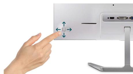
Diskretno postavljena tipka za preklapljanje po meniju EasySelect vam omogoča hitro in enostavno prilagajanje nastavitev monitorja v meniju na zaslonu.
