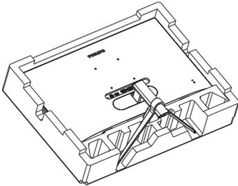
2. Remova a tampa da dobradiça do corpo do monitor utilizando uma ferramenta auxiliar.
