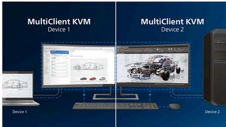
Con el conmutador multicliente integrado de KVM, podrás controlar dos ordenadores distintos con una única configuración de monitor, teclado y ratón. Además, podrás cambiar rápidamente entre las fuentes con solo pulsar un práctico botón. Resulta útil para configuraciones que requieren la potencia de dos ordenadores o que comparten un monitor de gran tamaño para mostrar dos equipos diferentes.
