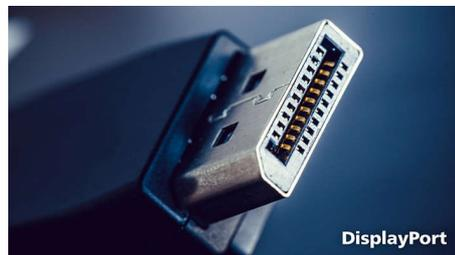
DisplayPort es una conexión digital del PC al monitor sin ninguna conversión. Con mayores capacidades que el estándar DVI, es totalmente capaz de soportar hasta 15 metros de cables y una transferencia de 10,8 Gbps por segundo. Con este alto rendimiento y sin retraso, consigues las imágenes y las frecuencias de actualización más rápidas; así DisplayPort es la mejor opción no solo para el uso en una oficina o en casa, sino también para los exigentes juegos y películas, la edición de vídeos y mucho
