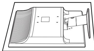
2. Нажмите фиксирующие зажимы, чтобы отсоединить подставку монитора от стойки основания.
