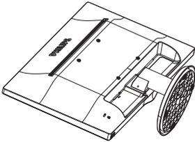
2. Drücken Sie zum Entfernen der Basis von der Basissäule die Freigabeclips zusammen.
