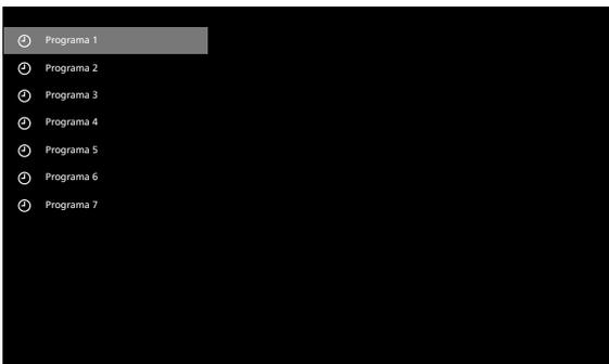
Presione el botón [↵] o [↩] para seleccionar un elemento de programación (número de elemento 1 - 7) y presione el botón [ACEPTAR] o [D] para entrar en el submenú.
