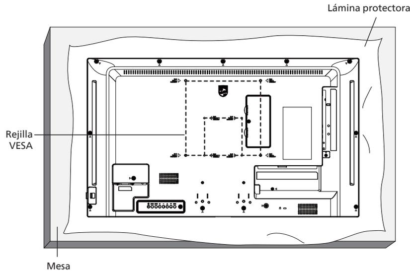
1. Extienda una lámina protectora sobre una superficie plana, por ejemplo, la que envolvía a la pantalla en el embalaje, debajo de la superficie de la pantalla. Coloque la pantalla boca abajo sobre la lámina protectora para facilitar la operación sin rayar la pantalla.
