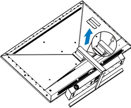
2. Lösen Sie die Befestigungsschrauben, nehmen Sie dann die Basen vom Monitor ab.
