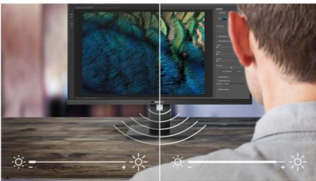
PowerSensor je ugrađeni senzor za prepoznavanje korisnika koji odašilje i prima infracrvene signale koji nisu štetni radi određivanja nalazi li se korisnik ispred monitora te omogućava automatsko smanjenje svjetline monitora kada se korisnik udalji od stola, čime se troškovi za energiju smanjuju za do 80 posto i produžuje vijek trajanja monitora
