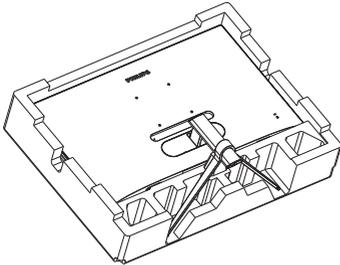
2. Retirez le couvercle à charnière du châssis du moniteur à l'aide de l'outil auxiliaire.
