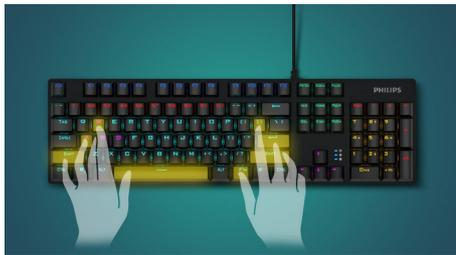
Per sequenze di tasti complesse e veloci sono necessarie prestazioni avanzate. Con il rollover N-key completo, ogni tasto è registrato in maniera indipendente senza pericolo di confusione, in modo che ogni pressione venga rilevata correttamente a prescindere da quanti altri tasti siano premuti o tenuti premuti contemporaneamente.
