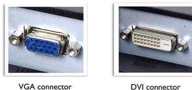
Double entrée avec connecteurs pour signal analogique VGA et signal numérique DVI.
