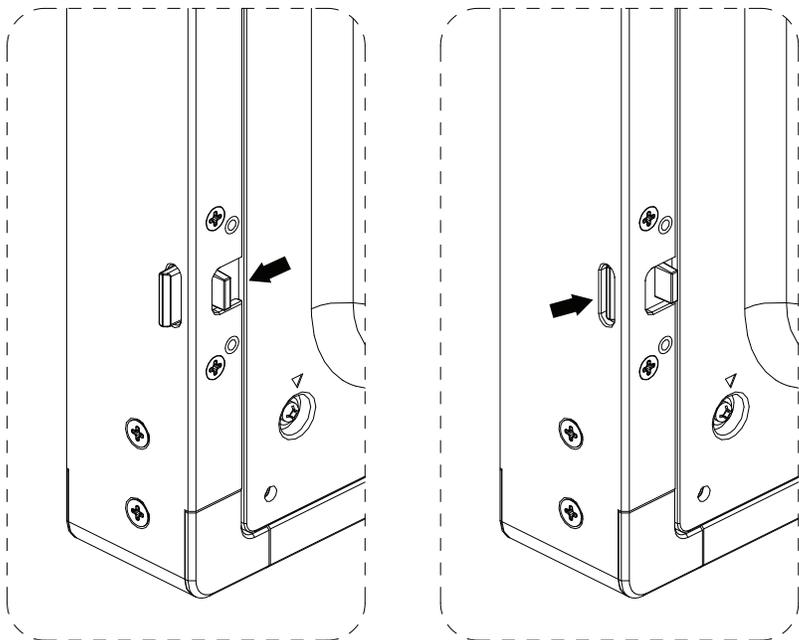
1. 向左拉動鏡頭以獲得最佳的遙控效能，同時可輕鬆觀察電源狀態的燈號資訊。
