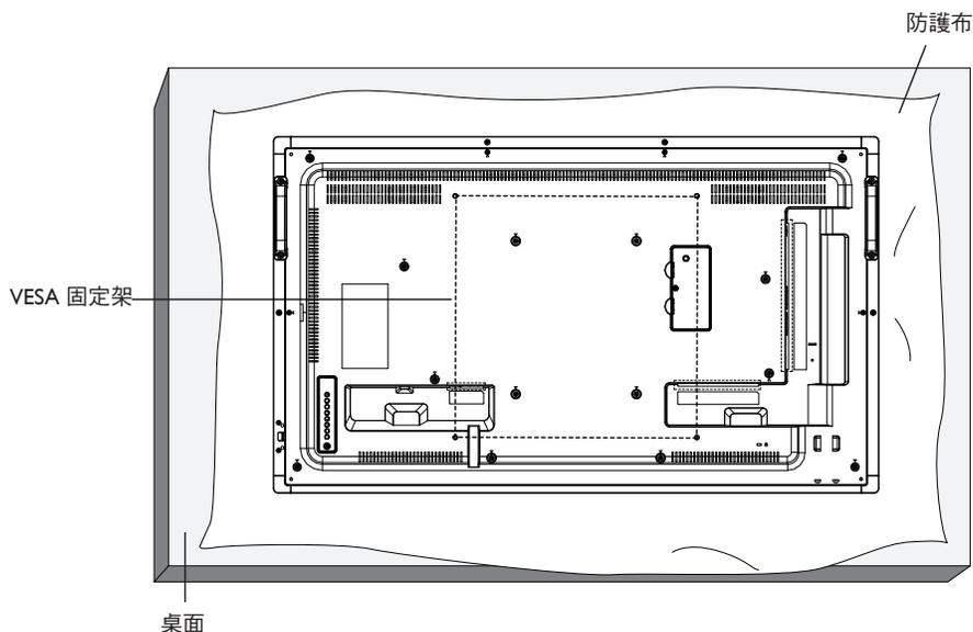
1. 將包裝時包覆顯示器的防護布鋪在桌面上，將螢幕朝下擺放防護布上，以免刮傷螢幕表面。
