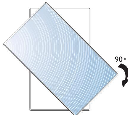
注意: 旋转显示器时, "AC IN" 插口应位于所有接口的下方
