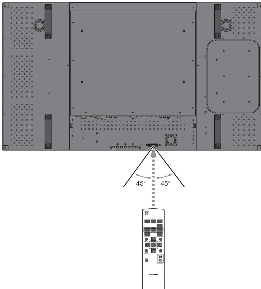
*注意：当阳光或其它强烈的光线照射在显示器上的遥控感应器上，或遥控器与遥控感应器之间有障碍物时，遥控器可能无法正常工作。*
