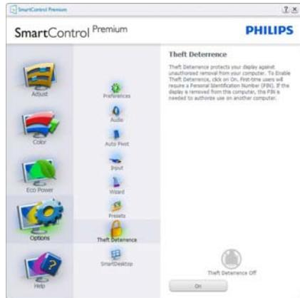
Для включения функции Theft Deterrence (Защита от кражи) Click on **On** кнопку, после чего отобразится следующий экран:
