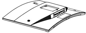
2. Halten Sie den Ständer mit beiden Händen. Bringen Sie den Ständer vorsichtig an der VESA-Halterung an, bis der Ständer an der Verriegelung einrastet.
