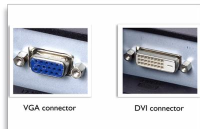
La doble entrada proporciona conectores para entrada de señales VGA analógicas y DVI digitales.
