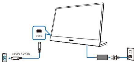
El puerto USB-C de este monitor puede suministrar 15 W y 5 V/3 A de potencia para cargar el dispositivo.
