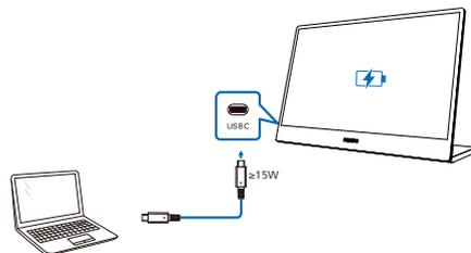
El monitor puede recibir alimentación de un dispositivo a través de USB-C, que admite hasta 65 W con 5 V/3 A, 7 V/3 A, 9 V/3 A, 10 V/3 A, 12 V/3 A, 15 V/3 A, 20 V/3,25 A
