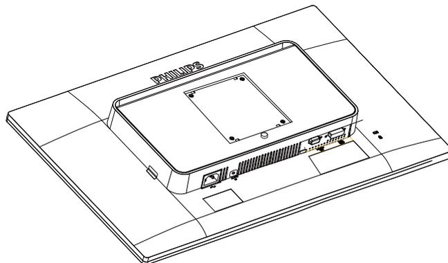
2. Přichyťte podstavec do umístění držáku VESA.
