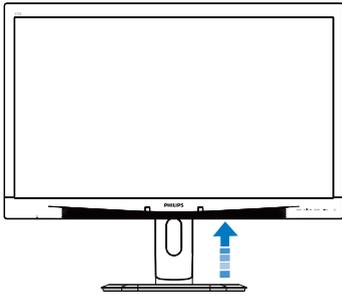
2. 將顯示器面朝下放在平面上。小心不要刮傷或損壞螢幕。接下來，抬起顯示器支架。
