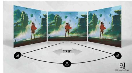
В дисплеях IPS используется прогрессивная технология, обеспечивающая широкий угол обзора 178/178 градусов для просмотра практически под любым углом. По сравнению со стандартными TN-панелями, дисплеи IPS обеспечивают значительно более высокую четкость изображения и яркие цвета, что делает их идеальным решением не только для просмотра фотографий, фильмов и веб-сайтов, но также и для работы в профессиональных приложениях, где требуется точная передача цвета и яркости.
