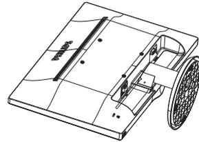
2. Drücken Sie zum Entfernen der Basis von der Basissäule die Freigabeclips zusammen.
