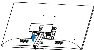
4. Pomoću odvijača uklonite vijke na nosaču, a zatim uklonite nosač/ postolje sa monitora.
