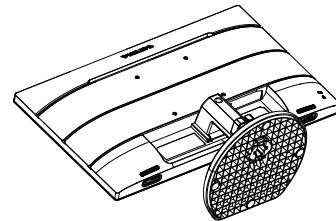
2. 按锁定夹，从底座支撑柱上卸下底座支撑臂。
