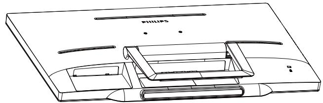
2. Bruk fingrene til å presse hengseldekselet forsiktig til kroken sklir ut av sporet.
