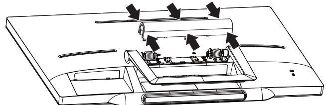
3. Bruk en skrutrekker til å løsne fire skruer.
