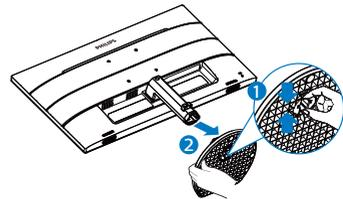
3. Вийміть гвинти з покриття петель.
